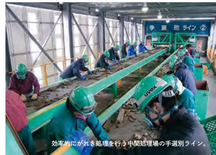
効率的にがれき処理を行う中間処理場の手選別ライン。
