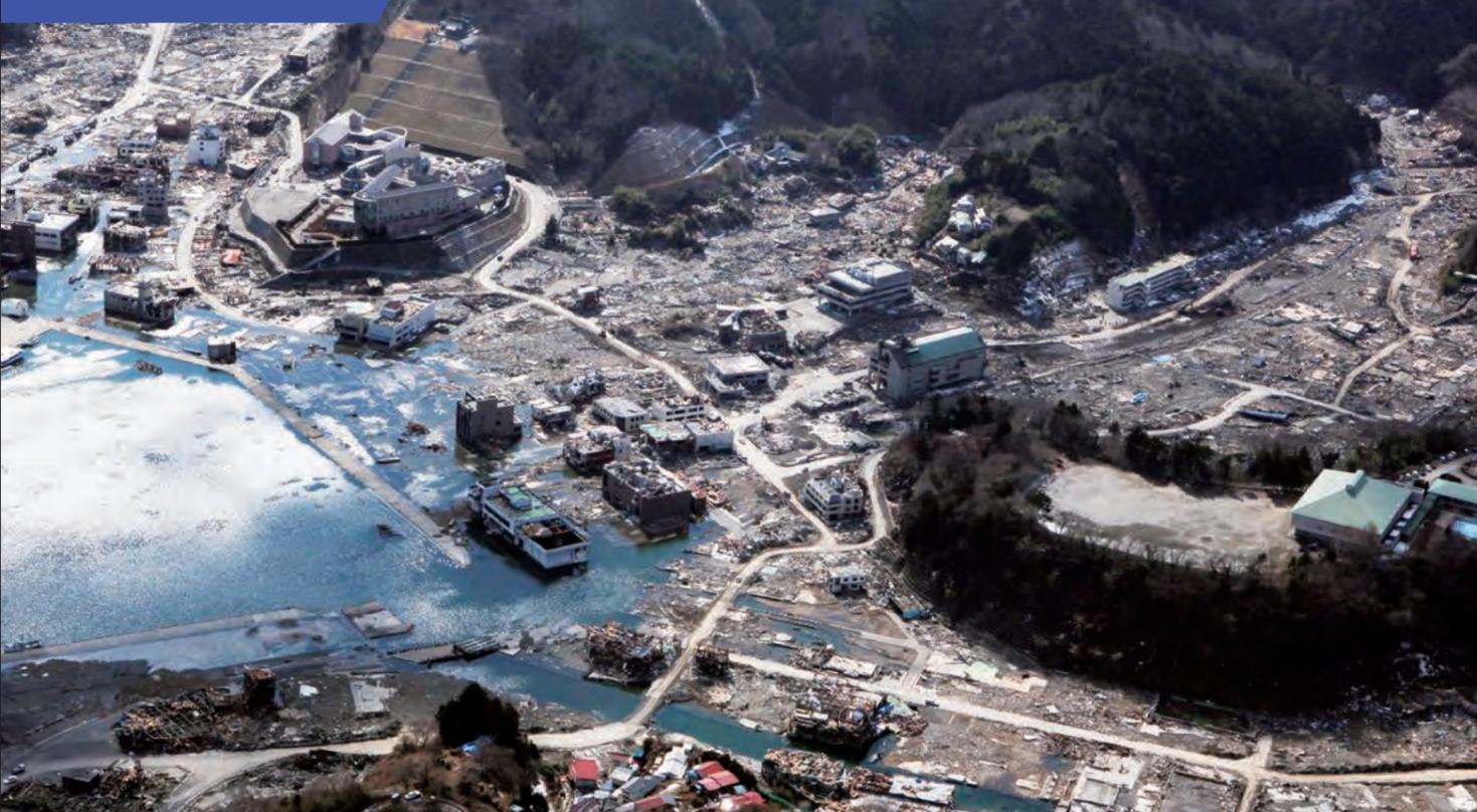
発災から1週間が経過した女川町中心部。鉄筋コンクリート以外の建物は跡形もない。地震により地盤沈下し、海沿いでは津波が引いた後も広範囲が浸水していた(2011年3月18日撮影)
